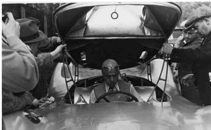
Bernd Rosemeyer mit Weste und Krawatte bei ersten Tests im April 1937. Schön zu sehen die einteilige Motor- und Cockpitabdeckung. © Unternehmensarchiv der AUDI AG
